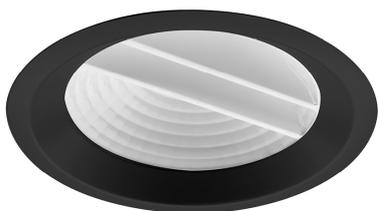
Downlights Empotrables: Elit Max. Disipador y marco fabricados en fundición de aluminio lacados con resinas epoxi-poliéster de alto rendimiento mediante aplicación electrostática y posterior polimerizado. Resistente a los rayos UV y a la corrosión. Reflector de plástico técnico de muy alta reflexión. Difusor: Asimétrico. Acabado: Negro.
