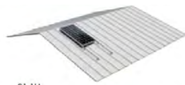
01.1H Disposición de los módulos en horizontal
